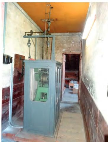
Fig. 273: Horloge mère mécanique de 1912, automatisée grâce à un électro-aimant installé par Muff.
