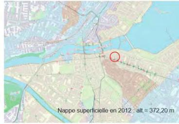
Fig. 43: Carte hydrogéologique : Nappes souterraines (jaune = superficielle, brun = temporaire, bleu/gris = principale). Prov. SITG.
