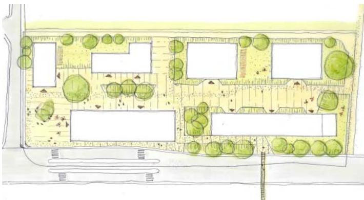
La dimension minimale de cette voie étant de 7 mètres pour une circulation motorisée à double sens et une circulation pour les piétons ou de 5 mètres pour une circulation mixte, celle-ci devra faire l'objet d'un travail pour éviter un traitement trop routier. Différentes variantes sont possibles. L'espace à disposition variera aussi en fonction des projets lauréats des concours qui pourraient libérer davantage d'espace pour un traitement plus qualitatif.
