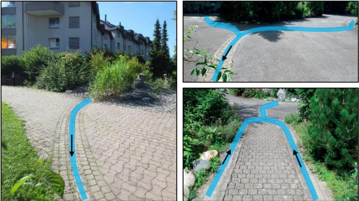
Figure 14 : Exemples d'évacuation et de gestion des eaux en surface (source VSA).
