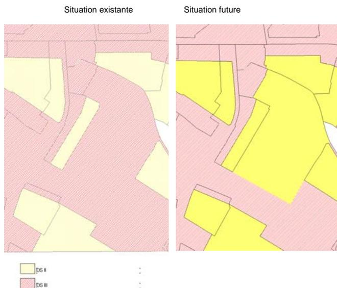
Il sera nécessaire de prévoir des solutions architecturales *ad hoc* (typologie ou dispositif intégrés) côté sud (voir sur les façades latérales) pour les bâtiments situés à la hauteur du front sud (dans la frange le long de la route de Malagnou), en tenant compte que les mesures de protection contre le bruit sur la voie de propagation (écrans) n'étant pas opérantes dans ce contexte de centre-ville et pour les bâtiments de ce gabarit (25m).
