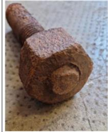
Exemple de corrosion des pièces en fer forgé de la lanterne avant traitement
