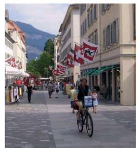
*Poststrasse : le dallage posé au milieu de la rue permet de canaliser les cyclistes, qui préfèrent utiliser cette bande de circulation plutôt que de rouler sur les pavés.*
