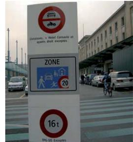
Genève, place de la Gare : combinaison des signaux « Circulation interdite aux voitures automobiles et aux motocycles » (signal 2.13) et « Zone de rencontre » (signal 2.59.5).
