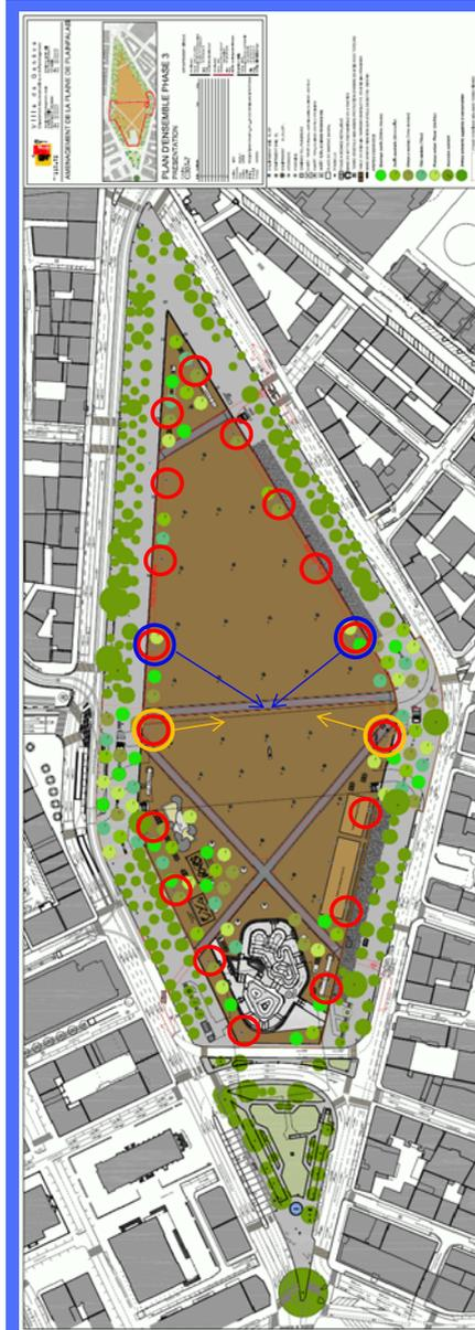
○ Mât 16 mètres avec 3 projecteurs HIT / puissance par mât: 290W
