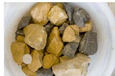
Figure 1. Pierres anguleuses utilisées pour le mélange terre-pierre.
